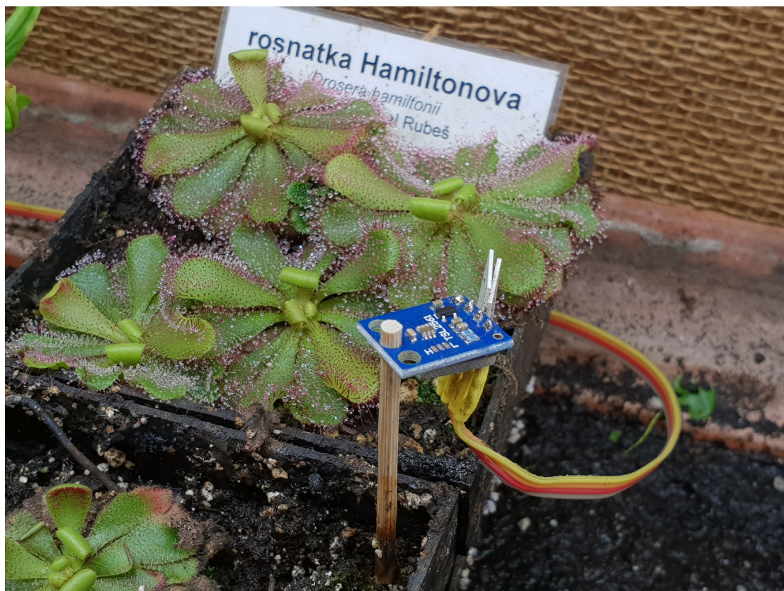
Čidlo osvětlení je nahoře, na spodní straně destičky je čidlo teploty, vlhkosti a tlaku.
